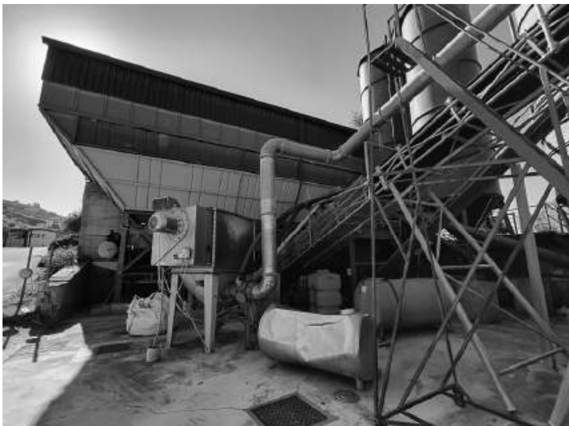
Foto 47 - Impianto di betonaggio, nastro trasportatore.
