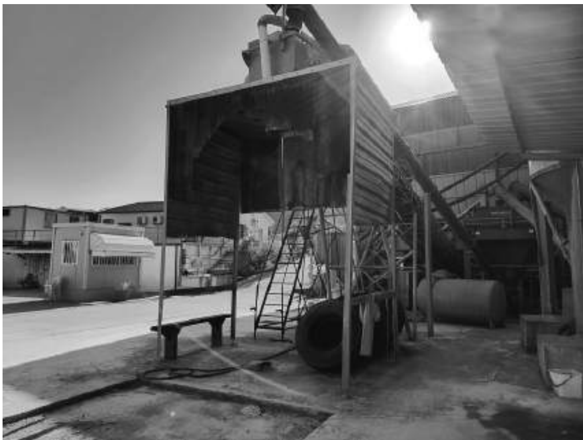
Foto 49 - Impianto di betonaggio, posto di carico autobetoniere.
