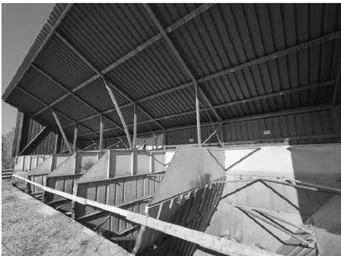
Foto 44 - Impianto di betonaggio, tramogge di carico inerti.
