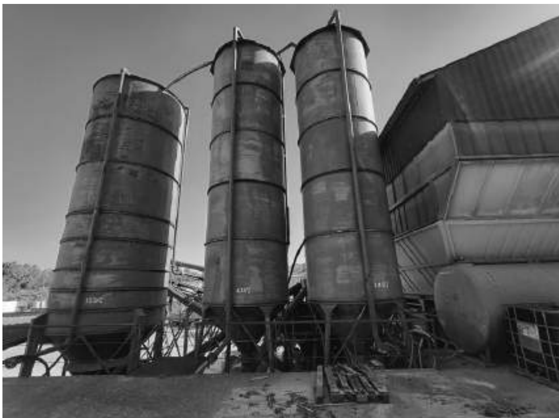
Foto 45 - Impianto di betonaggio, sili per il cemento.
